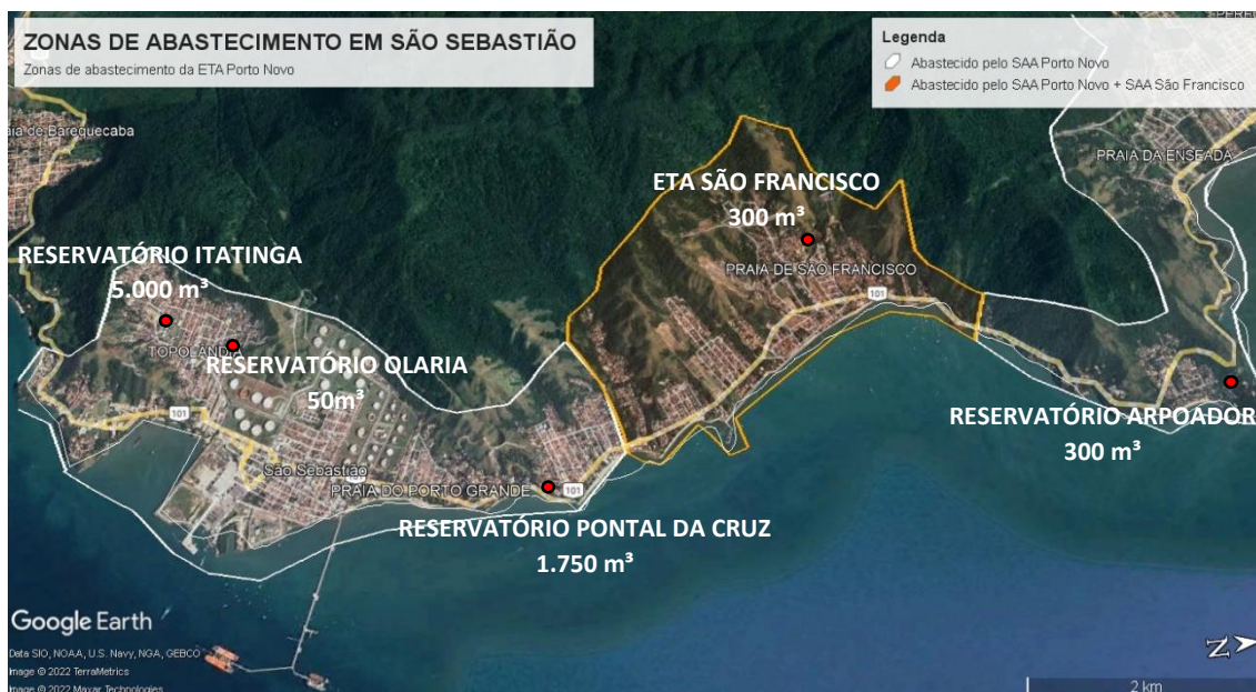
Figura 5 - Zona de abastecimento da ETA Porto Novo em São Sebastião (17,7 km de orla)
