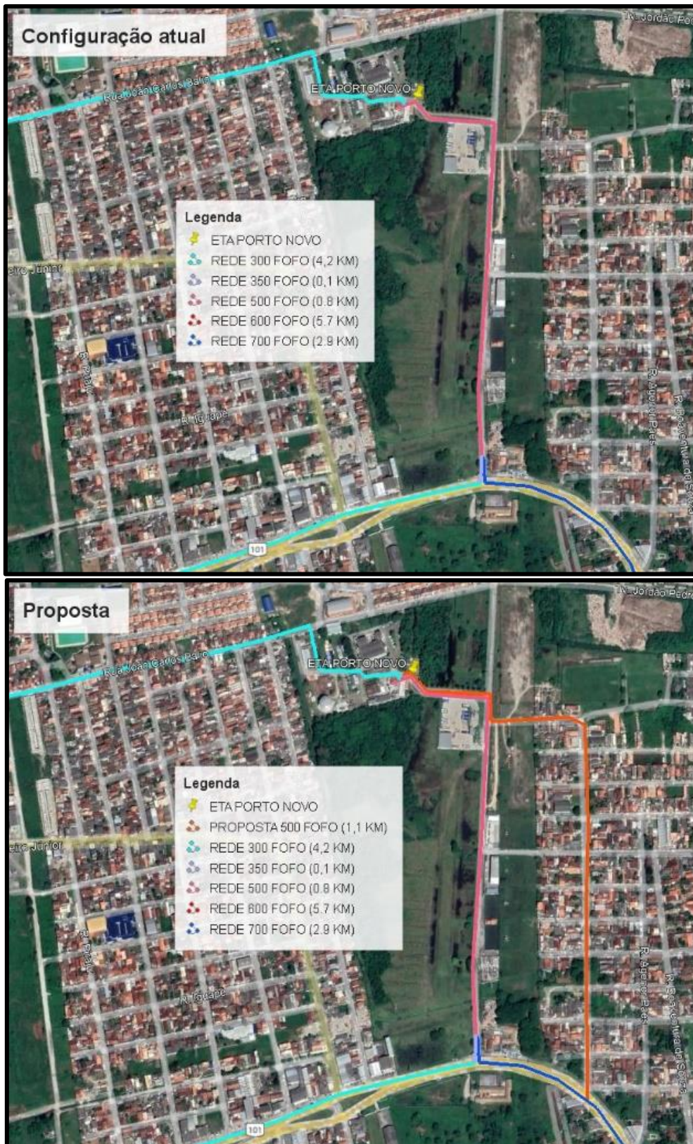
Figura 12 Acima é apresentada a configuração atual da rede, e abaixo o prolongamento proposto para melhoria do sistema
