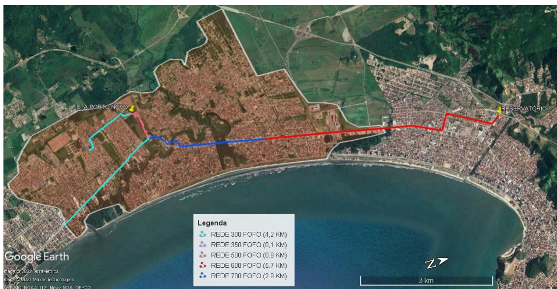
Figura 6 - Área abastecida pela rede que abastece o reservatório Palmeiras Norte
