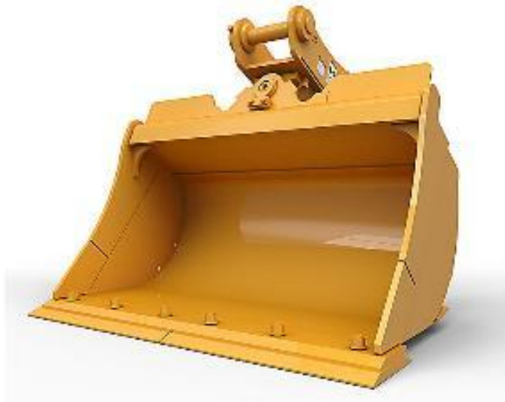
Figura 4 - Concha lisa, ideal para o procedimento de limpeza de gabiões.
