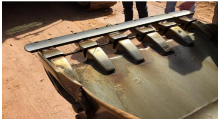
Figura 5 - Concha adaptada para o procedimento de limpeza de gabiões.
