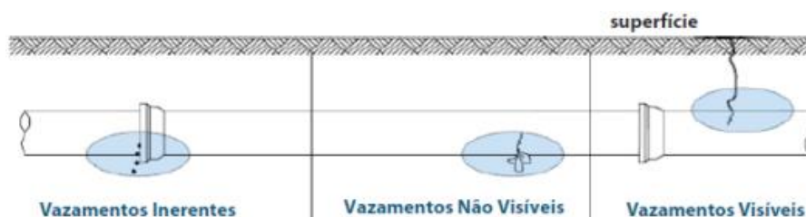
Figura 9 - Tipos de vazamentos. Fonte: FUNASA, 2014.
